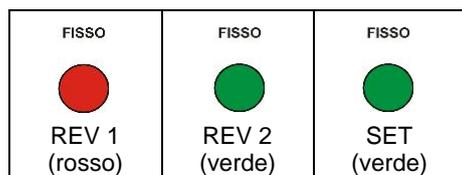
Mantenere premuto il tasto **PS1** per impostare l'ultimo tratto dell'apertura del **motore 1** in **rallentamento** e rilasciarlo solo al termine dell'apertura
