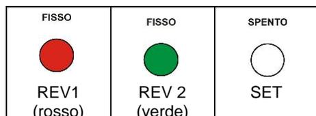
Mantenere premuto il tasto **PS1** per avviare il **motore 1**; rilasciare il tasto per fermare il movimento nel punto in cui si vuole fissare il **ritardo anta in apertura**.
